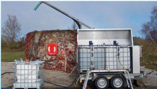
Wir wollen deshalb auf eine kontinuierliche Pressung mit kontinuierlicher Einspeisung des Filtratwassers umsteigen, um den biologischen Reinigungsprozess nicht zu belasten. Aktuell läuft ein Versuchsprojekt mit einer DrainTec-Filtersackentwässerung.
